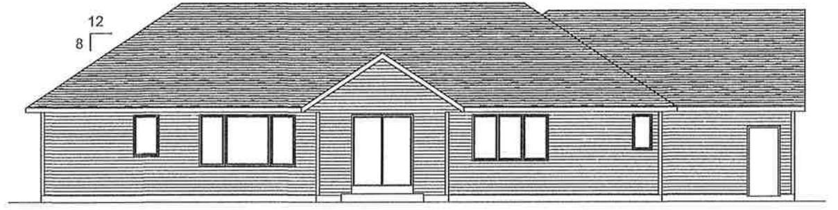
REAR ELEVATION SCALE: 1/8" = 1'-0"
